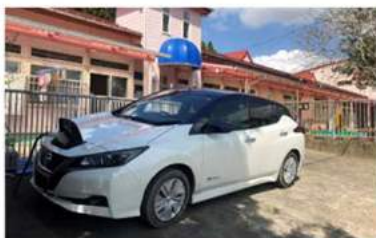
停電時に保育園へ給電 (令和元年 房総半島台風)
